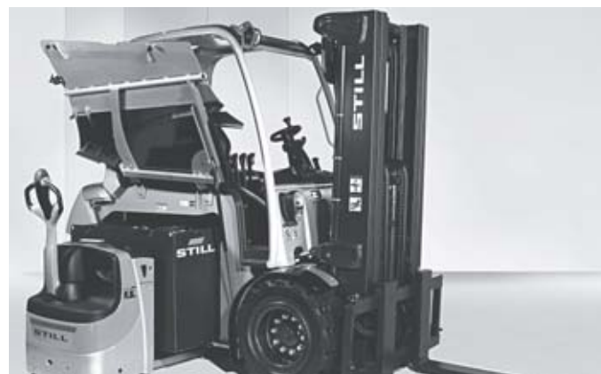
Sostituzione laterale semplice della batteria con transpallet e piastra di alloggiamento batteria
