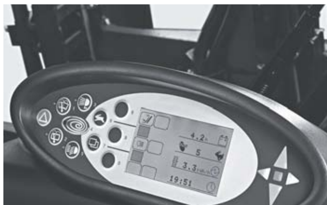
Visualizzazione del consumo di energia e di altre informazioni disponibile a livello centrale
