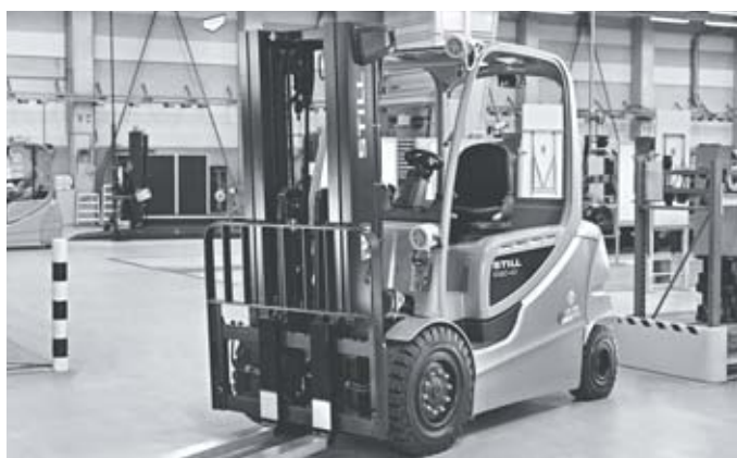
Versione di protezione EX con componenti elettrici integrati
