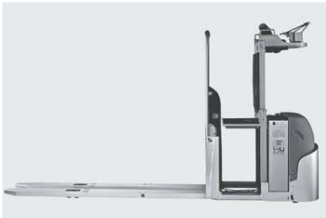
Sollevamento pedana con guida in quota per picking veloce ed ergonomico
