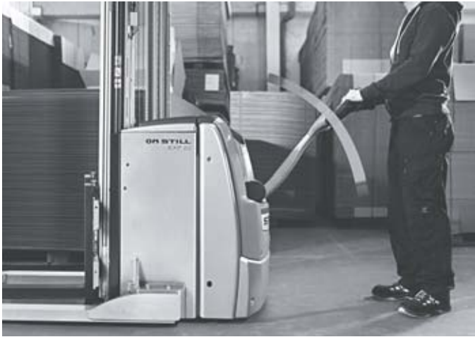
Sicurezza nella produzione: a seconda dell'angolo del timone, la velocità viene automaticamente adattata così da assicurare la massima sicurezza nella distanza tra l'operatore e il carrello elevatore
