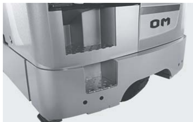
Ingresso sicuro grazie al gradino
