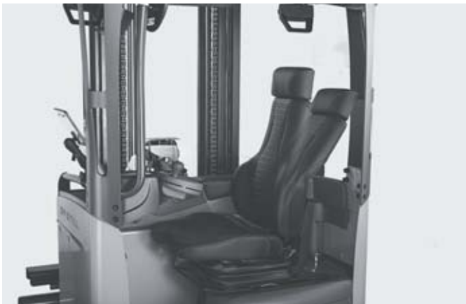
Comodo sedile inclinabile per un'ottima visibilità verso l'alto
