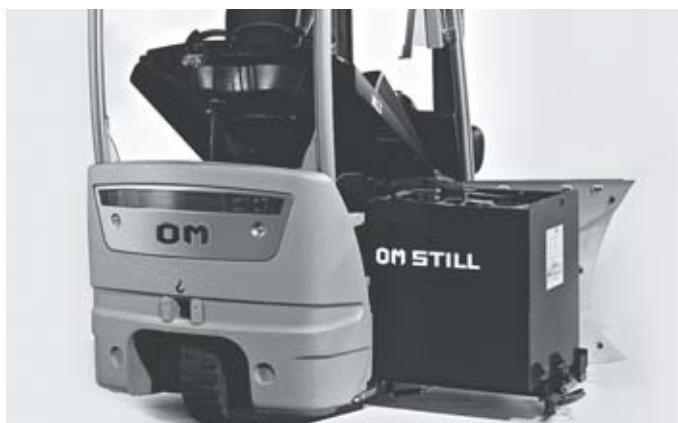
Ponte batteria a bordo per la sostituzione laterale della batteria tramite gru
