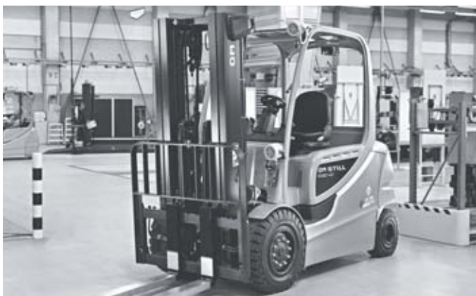
Versione di protezione EX con componenti elettrici integrati
