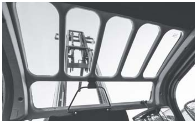
Massima visibilità grazie alle numerose finestre e al tettuccio protettivo dal profilo snello
