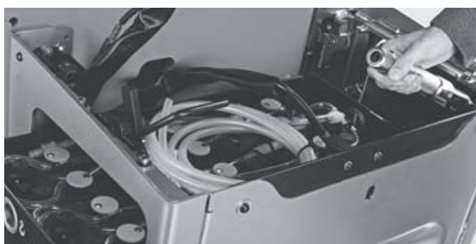
Cambio batteria veloce e sicuro grazie all'innovativo blocco batteria
