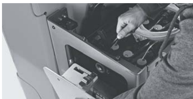
Vano batteria disponibile con porta laterale per proteggere la batteria in caso di urti
