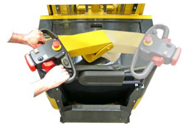
Versione con sterzo elettrico
